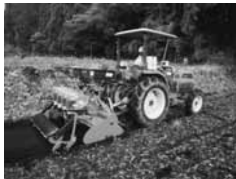
図9 アップカットロータリによる表層散播 写真：九州沖縄農業研究センター 土屋氏
